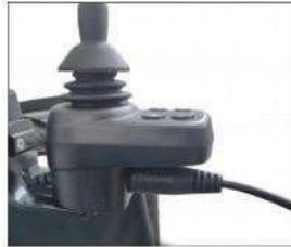
3. Cuando el indicador de carga del cargador se pone verde, indica que la potencia es suficiente. Desenchufe el cargador y el enchufe de salida de carga cuando sea suficiente.
